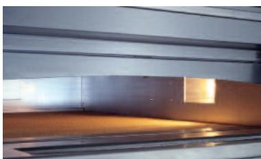
camera con piano in refrattario e vaporiera per la cottura di pane
